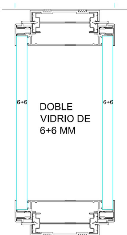
La solución acristalada está compuesta por dos vidrios laminados de 6+6 mm, una cámara de aire de 89 mm y otro vidrio laminado de 6+6 mm todo unido mediante perfilaría de aluminio tal y como se puede ver en la imagen anterior.
